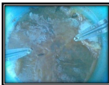
Gambar 3. Sludge Blanket Pada Hasil Pengamatan setelah 5 Minggu.
